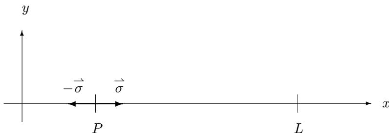
In diesem Fall heben sich in jedem Punkt  $P$  auf der Saite die angreifenden Kräfte  $\vec{\sigma}$  und  $-\vec{\sigma}$  auf. Wir gehen im folgenden davon aus, daß die Spannung in Ruhelage  $|\vec{\sigma}|$  bekannt ist.
