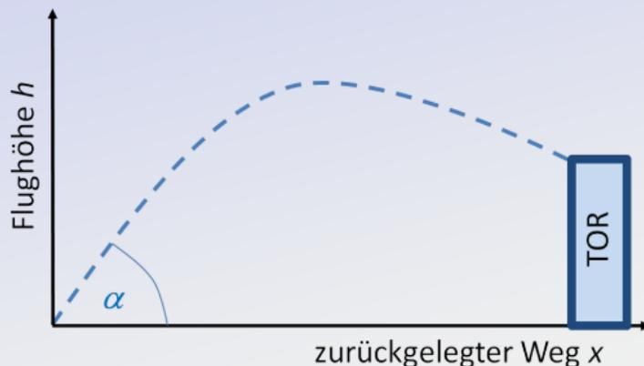
Flughöhe und zurückgelegter Weg in Abhängigkeit von der Zeit  $t$ , der Abschussgeschwindigkeit  $v$  und -winkel  $\alpha$
