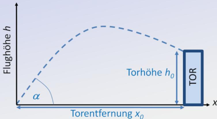
Überflughöhe in Abhängigkeit von Abschussgeschwindigkeit  $v$  und -winkel  $\alpha$
